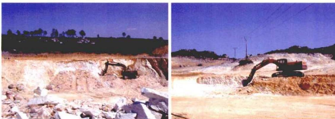
**Fotografía 29.-** Frentes de extracción, en la zona ripable, en las canteras Candamil (izquierda) y Vilabesas (derecha).
