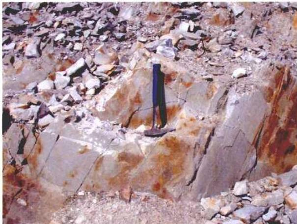
**Fotografía 38.-** Detalle de uno de los tramos de cuarcitas muy blancas y puras, de grano muy fino, masivas y muy resistentes (P002021).
