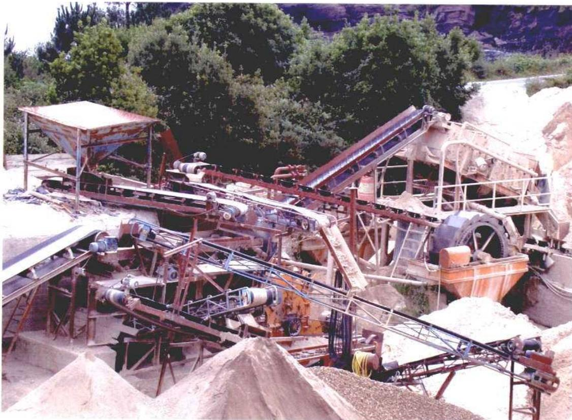
**Fotografía 31.-** Instalación de machaqueo, lavado y clasificación en la estación P009028 (Foz).
