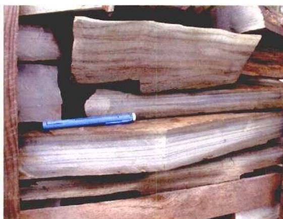
**Fotografía 14.-** Detalle del material extraído con laminaciones (P024011).
