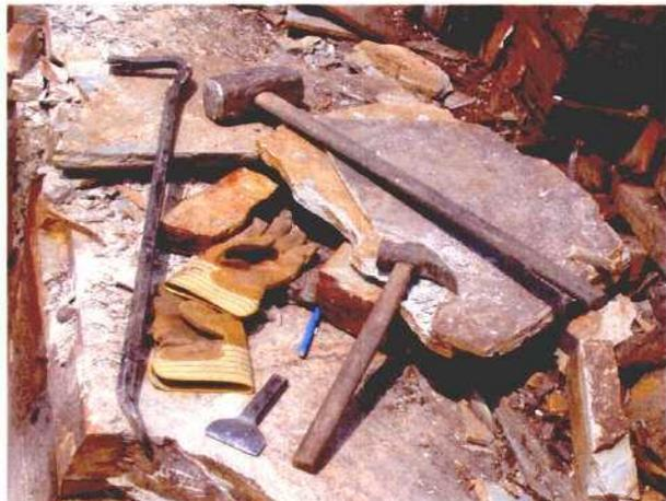
**Fotografía 10.-** Útiles para el trabajo de obtención de chapa y plachón.
