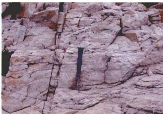
**Fotografía 70.-** Cuarcitas blancas muy resistentes y puras, muy fracturadas. Punto 13.
